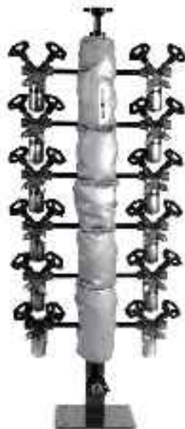
CCAF 212 凝结水回收管束 (图示中有安装2000系列全不锈钢疏水阀的TVS4000疏水阀站，可选可拆式保温层，接管、排水阀及支架。)
